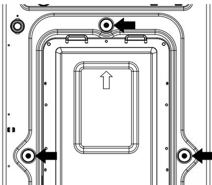
2. Открутите 3 болта при помощи 10мм гаечного ключа или отвертки. Сохраняйте транзитные болты.
